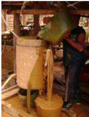
Fig. 6.10.: Ciclón de lodos
