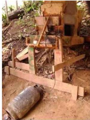
Fig.6.13 y 6.14. Horno artesanal para separación térmica
